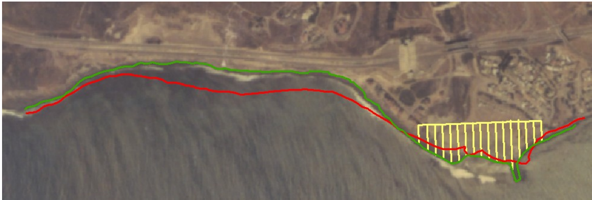
Fotografía 10.- Línea de costa, transectos y fotografía aérea de 1973, y línea de costa de 1985.
